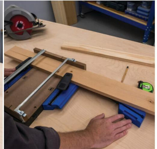
Avec la station de tronçonnage Kreg KMA4100, vous pouvez couper des feuilles jusqu'à 305 mm (12") de large rapidement et avec précision. Vous pouvez également utiliser cette station de sciage pour effectuer des coupes d'onglet de 0° à 45°. Avec la station de sciage Kreg, vous pouvez couper avec votre scie circulaire aussi précisément qu'avec une scie à onglet.
