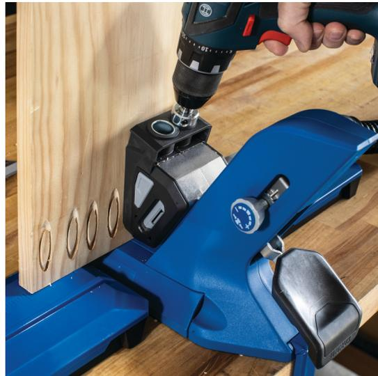
Le Kreg Pocket-Hole Jig 720 et le Kreg Pocket-Hole Jig 720 Pro sont compatibles avec le gabarit de perçage de chevilles Kreg KPHA740. Avec ce foret à cheville, vous pouvez percer vos propres chevilles en fonction de votre projet.
