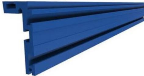
Le Heavy-Duty Trak est un profilé en aluminium anodisé en forme de "L", extrêmement droit et idéal pour les applications commerciales lourdes. Ce Trak contient quatre rainures en T qui accueillent la tête d'un boulon hexagonal standard de 1/4" (6 mm). Une encoche fraisée de 13 mm (1/2") court le long du haut et de l'avant du Trak pour faciliter la fixation d'un mètre ruban adhésif (vendu séparément).
