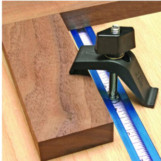
Vous pouvez utiliser la Mini-Trak pour fabriquer de nombreux types de gabarits et d'étaux pour le travail du bois, tels que des gabarits coniques et des glissières de coupe. Cette adaptation de nos populaires Traks possède une rainure en T dans laquelle s'insère la tête d'un boulon hexagonal standard de 6 mm. Un trou est prévu tous les 10 centimètres pour le vissage du profilé.
