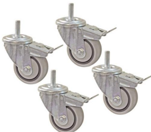
Les roulettes Kreg Heavy Duty peuvent être montées sous votre établi universel. De cette façon, vous pouvez facilement déplacer votre poste de travail personnel. Les roues sont en acier et équipées d'un frein puissant. Ce frein puissant garantit que votre établi ne roulera pas. La capacité de charge par roue est de 70 kg. L'ensemble (4 roues) a donc une capacité de charge de 280 kg. Ils ont une taille de 7,6 cm.
