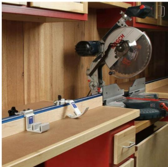
Le Top Trak de Kreg est un rail en aluminium qui peut être facilement fixé à un guide existant. Grâce à sa forme en L, le rail s'adapte bien à l'arrêt existant. Percez des trous de Ø 3 mm au dos et fixez-les avec les vis fournies. Longueur 1219 mm (48"). Convient pour les boulons de 6 et 6,3 mm.
