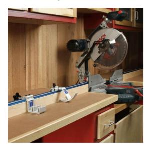
Le Top Trak de Kreg est un rail en aluminium qui peut être facilement fixé à un guide existant. Grâce à sa forme en L, le rail s'adapte bien à l'arrêt existant. Percez des trous de Ø 3 mm au dos et fixez-les avec les vis fournies.
