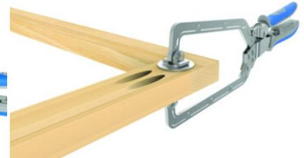
Le serre-joint rapide en métal de Kreg a une capacité de serrage de 152 mm. La pince possède de grandes surfaces de serrage pour éviter d'endommager les surfaces. La pince s'adapte automatiquement à toute épaisseur de matériau et maintient une pression de serrage constante grâce à la technologie Automaxx de la poignée. Compatible avec Kreg Jig®, le pied guide de perçage portable Kreg et Kreg Jig® R3.
