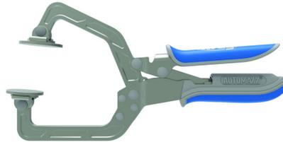
Le serre-joint rapide en métal de Kreg a une capacité de serrage de 76 mm. La pince possède de grandes surfaces de serrage pour éviter d'endommager les surfaces. La pince s'adapte automatiquement à toute épaisseur de matériau et maintient une pression de serrage constante grâce à la technologie Automaxx de la poignée. Compatible avec Kreg Jig®, le pied guide de perçage portable Kreg et Kreg Jig® R3.
