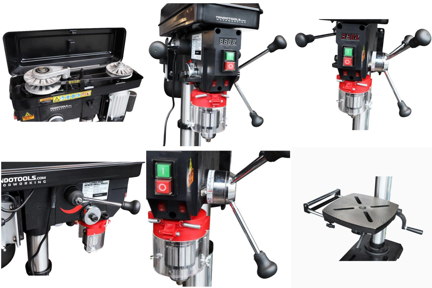
Cette perceuse à colonne unique fonctionne avec une vitesse variable et réglable (Variomatic). Cette fonction de vitesse variable vous permet de définir la bonne vitesse pour chaque projet (de 440 à 2850 t/min) sans avoir à déplacer les courroies ou à ouvrir la boîte de vitesses.
