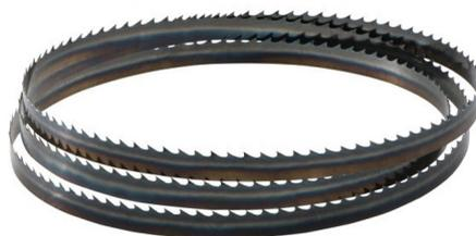
Lame de scie à ruban d'une longueur de 4590 mm à utiliser sur la scie à ruban TT600 de Tendotools. Ce ruban de scie a 14 TPI (dents par inch) et a une largeur de 27mm. Ce lame de scie à ruban bimétallique est très solide et, outre le bois ou le plastique, il convient même au sciage des alliages de métaux légers ou, par exemple, de l'aluminium. Il est également recommandé d'utiliser ces lames de scie pour une utilisation à long terme sur les bois durs.
