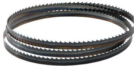
Lame de scie à ruban d'une longueur de 4670mm à utiliser sur la scie à ruban TT50BS ou TT61BS de Tendotools. Ce ruban de scie a 14 TPI (dents par inch) et a une largeur de 27mm. Ce lame de scie à ruban bimétallique est très solide et, outre le bois ou le plastique, il convient même au sciage des alliages de métaux légers ou, par exemple, de l'aluminium. Il est également recommandé d'utiliser ces lames de scie pour une utilisation à long terme sur les bois durs.
