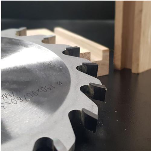
Lame de scie pour rainures avec denture plate (FZ) widia pour faire des rainures dans des bois durs, tendres, exotiques et des panneaux avec revêtement en plastique. Les lames de scie ont un alésage de 30mm et sont idéal à utiliser sur des toupies ou des scies à table.
