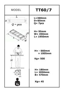
Le TT60/7 est un lit à rouleaux avec 7 rouleaux sur roulements à billes.
