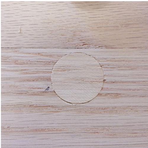
Mèche à bouchons à utiliser avec tous les types de bois. Pour réaliser des tourillons en bois après l'utilisation de mèches Forstner. Utilisez les tourillons après avoir installé les vis à tête fraisée et poncez le haut de l'étau au ras de la surface du bois pour créer un assemblage par vis quasi invisible. Cette mèche a une longueur de 140mm et 4 dents en SP.
