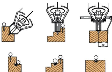
Mèche carbure ancre double à utiliser sur le rainureuse Virutex RA17VG. Cette fraise permet de fraiser les joints en silicone de type FS2 ou FS4.
