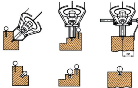
Mèche carbure droite double à utiliser sur le rainureuse Virutex RA17VG. Cette fraise permet de fraiser les joints en silicone de type FS1 ou FS3.
