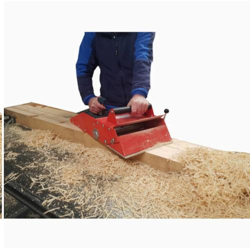
Le rabot de menuiserie CPL 200 est fabriqué en aluminium et en acier, et dispose d'un arbre de rabotage tout en acier avec deux couteaux de rabotage.
