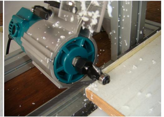
Avec ce affleureuse de chants, vous disposez d'une automatisation abordable. Grande plaque de support réglable recouverte de supports en téflon. Vous fraisez le côté, le coin et le dessus en un seul mouvement de droite à gauche.
