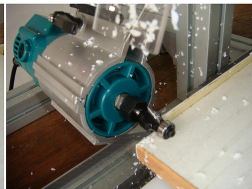
Avec ce affleureuse de chants, vous disposez d'une automatisation abordable. Grande plaque de support réglable recouverte de supports en téflon. Vous fraisez le côté, le coin et le dessus en un seul mouvement de droite à gauche.
