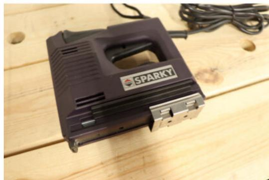
Une machine à clouer et à agraffer qui peut être réglée au moyen d'une commande électronique. Grâce à son boîtier ergonomique et bien équilibré, cet outil puissant vous sera d'une aide précieuse lors de vos travaux. Cet appareil permet de poser aussi bien des agrafes (6 à 14 mm) que des clous (16 cm maximum). L'appareil est doté d'un double interrupteur de sécurité. Le chargeur a une capacité de 83.
