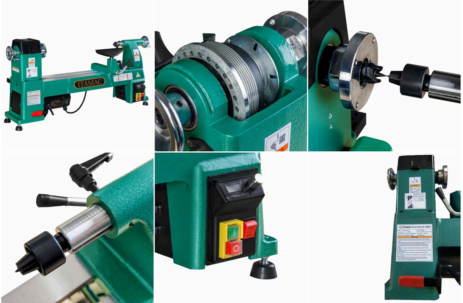
L'itamac WL-508DC est un tour à bois très stable, avec contrôle de la vitesse par **vario-inverter**, tournant à gauche et à droite, avec un diamètre de tournage de 320 mm et 508 mm entre les pointes. La vitesse peut être réglée en continu dans 3 plages comprises entre 250 et 3850 tr/min. (250-750 / 550-1650 / 1300-3850 tr/min).
