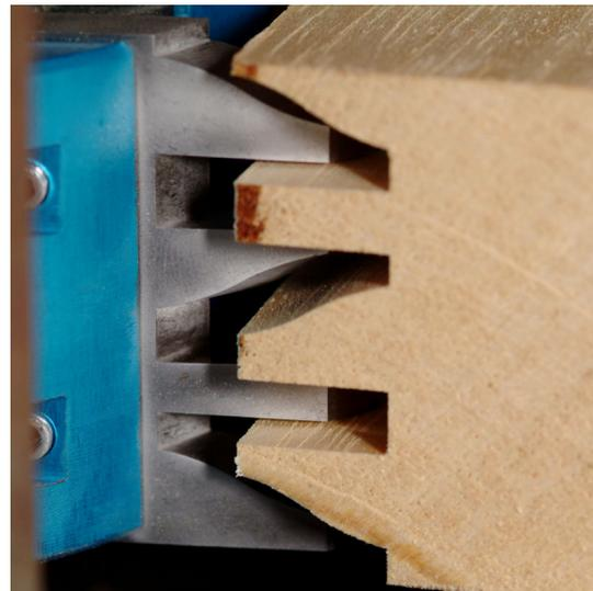
Set de couteaux profilés hauteur 40mm Nr. 0068 pour des porte-outils à profiler universels. Approprié pour le fraisage de profilés de chants en bois massif avec un faible coût d'outillage. Acier à outils allié avec 16% cobalt pour un qualité de coup très haut et un fraisage confortable.
