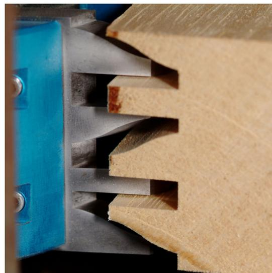
Set de couteaux profilés hauteur 50mm Nr. 2047 pour des porte-outils à profiler universels. Approprié pour le fraisage de profilés de chants en bois massif avec un faible coût d'outillage. Acier à outils allié avec 16% cobalt pour un qualité de coup très haut et un fraisage confortable.
