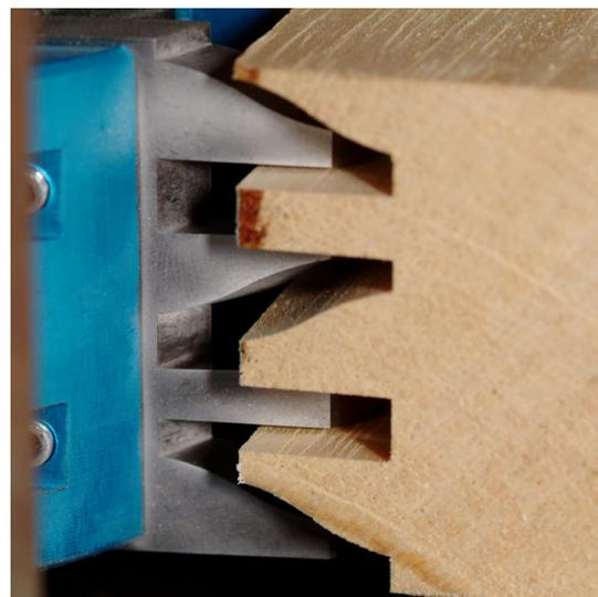
Set de couteaux profilés hauteur 50mm Nr. 2057 pour des porte-outils à profiler universels. Approprié pour le fraisage de profilés de chants en bois massif avec un faible coût d'outillage. Acier à outils allié avec 16% cobalt pour un qualité de coup très haut et un fraisage confortable.
