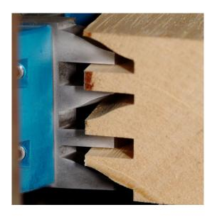
Set de couteaux profilés hauteur 90mm Nr. 5322 pour des porte-outils à profiler universels. Approprié pour le fraisage de profilés de chants en bois massif avec un faible coût d'outillage. Acier à outils allié avec 16% cobalt pour un qualité de coup très haut et un fraisage confortable.
