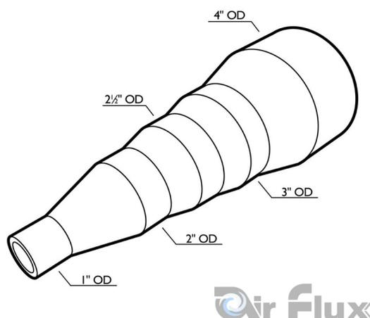
Pièce de réduction à utiliser avec les modèles différents des aspirateurs Air Flux. A couper sur le propre diamètre.
