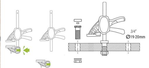
Cet accessoire permet d'utiliser facilement le Mini Quick de Piher sur des établis avec des trous de Ø 19 mm ou Ø 20 mm. En retirant l'une des mâchoires du Mini Quick, vous pouvez facilement monter la tige dans l'accessoire sur l'établi, ou monter la mâchoire mobile à l'horizontale. Cet accessoire peut donc être utilisé horizontalement ou verticalement, selon votre préférence.
