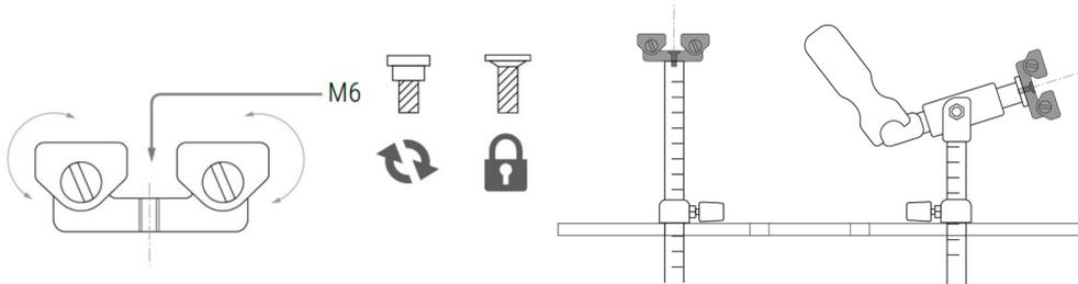
Cet adaptateur de tube est conçu pour la pince de piston TCP. Galvanisé et fabriqué en acier au carbone.
