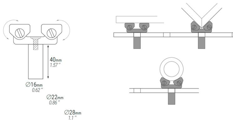
Cet adaptateur pour tubes est conçu pour les tables de soudage et est disponible en diamètre 16 mm, 22 mm ou 28 mm. Galvanisé et fabriqué en acier au carbone.
