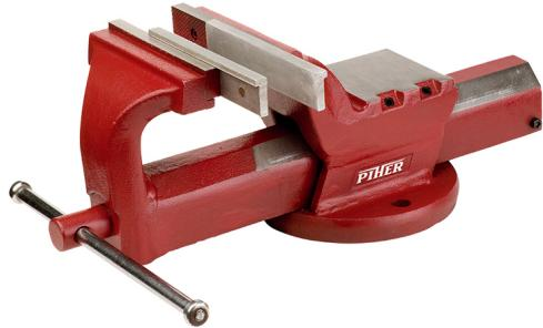
Ces étaux robustes à mâchoires carrées sont fabriqués en acier forgé C-40 et sont donc très résistants. Ils ont des mâchoires carrées réglables qui peuvent être remplacées, comportent une base d'enclume et sont livrés en standard avec des plaques de pression magnétiques en aluminium. Vous pouvez facilement monter les étaux à travers les trous fournis. Vous pouvez également les monter dans une base rotative en option. Disponible en trois tailles. Un vrai must pour l'atelier sérieux!
