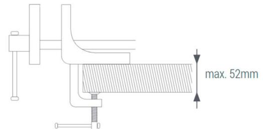
Cet étau mobile d'atabli menuisier peut être facilement monté sur tous les plans de travail d'une épaisseur allant jusqu'à 52 mm. Il est fait de fonte et d'une poignée rotative en acier. Les mâchoires ont une largeur de 15 cm, une hauteur de 5,5 cm et une épaisseur de serrage maximale de 12 cm.
