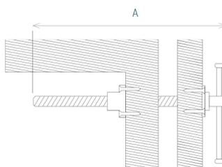
Arbre d'étau séparé pour fabriquer votre étau d'etabli. L'arbre dispose d'une grande poignée à bascule, tout comme les étaux standard, et est fabriqué en acier forgé C-40 avec une dureté d'acier de 45-51 HRC. Disponible en différents diamètres.
