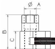
Cet accessoire est utilisé pour desserrer des boulons dont la tête est endommagée ou ne peut pas être retirée avec une clé. Fabriqué entièrement en acier trempé et disponible en trois tailles différentes.
