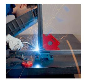
Les équerres magnétique de Piher peuvent être utilisés pour souder des angles de 45 ° et 90 °. Ils utilisent un aimant en ferrite protégé par de la bakélite résistant aux températures élevées.
