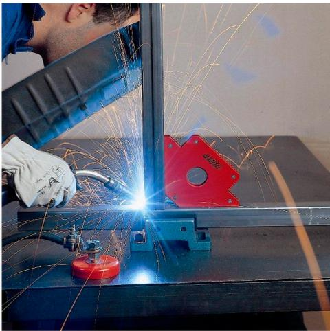
Les équerres magnétique de Pihér peuvent être utilisés pour souder des angles de 45 ° et 90 °. Ils utilisent un aimant en ferrite protégé par de la bakélite résistant aux températures élevées.
