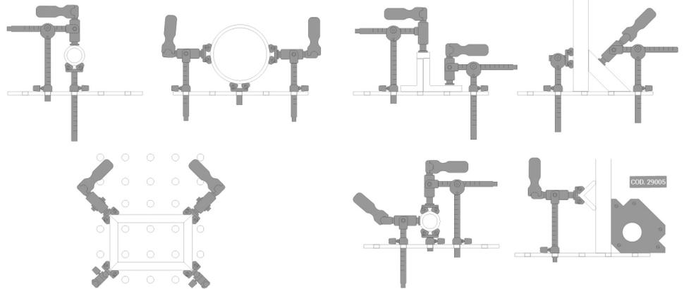
Cet ensemble composite de PIHER comprend trois pinces de table de soudage, un support à 90°, un accessoire de serrage de tubes et un aimant de soudage GRATUIT.
