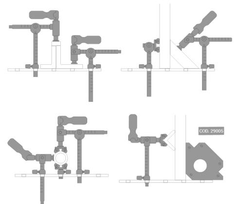
Cet ensemble composite de PIHER comprend trois pinces de table de soudage, un support à 90°, un accessoire de serrage de tubes et un aimant de soudage GRATUIT.
