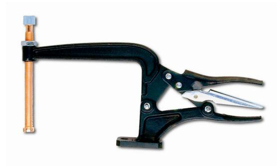
Ces pinces-étaux sont spécialement conçues pour les soudeurs. Le fil étant cuivré, les projections de soudure ne colleront pas à votre pince. Le corps est en acier forgé. Lorsque la vis cuivrée montre finalement une usure, elle peut être remplacée.
