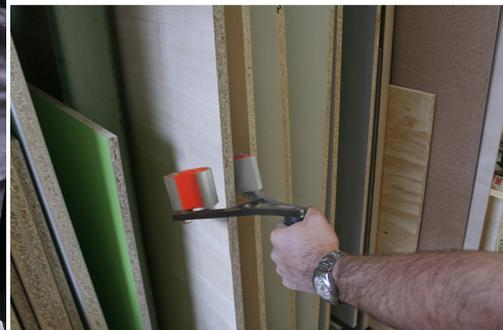
Support de panneau pour un levage et un déplacement faciles de tous types de matériaux en feuille. Boîtier entièrement en acier avec supports de serrage en caoutchouc. Ce support de panneau peut être utilisé pour le bois, le plastique, les métaux non gras et bien plus encore. Capacité de charge jusqu'à 75 kg.
