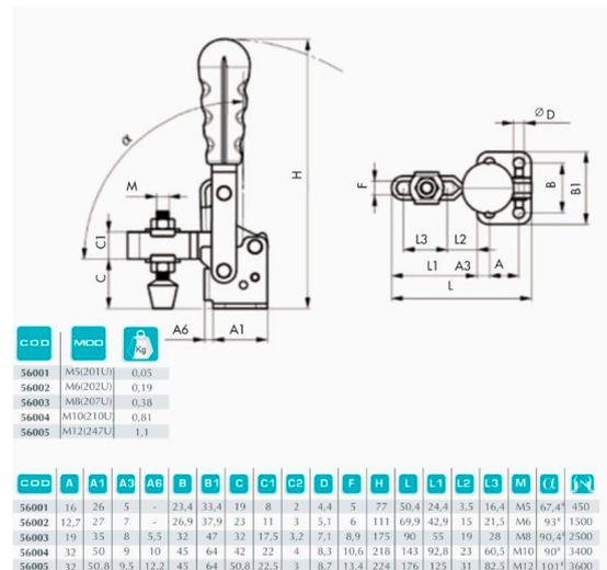
Sauterelle à serrage vertical en acier, avec poignée en PVC et pied de pression en néoprène souple pour éviter d'endommager votre pièce. Les sauterelles à serrage verticales sont disponibles en différentes tailles et résistances. Toutes les dimensions nécessaires peuvent être trouvées sur les photos.
