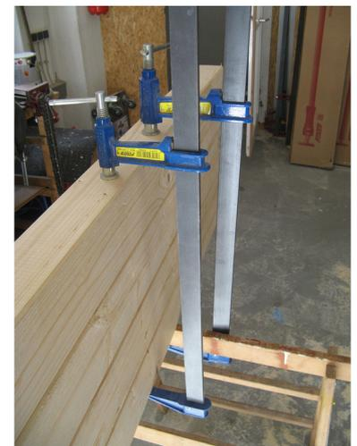
Le serre-joint à pompe Mod. F est un serre-joint en fonte avec filetage entièrement protégé, qui la protège des influences extérieures: morceaux de béton, attelle en acier, particules de soudure, etc. Le serre-joint à pompe a une barre en acier laminé très résistante et est traitée avec de l'antirouille. Ce serre-joint a une tête en fonte recouvert de peinture époxy, ainsi qu'un système d'arrêt antidérapant sur la tête mobile pour éviter une chute libre.
