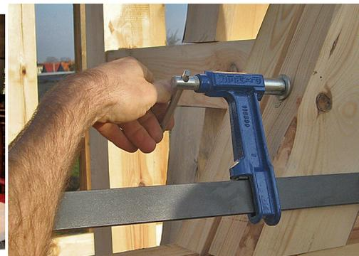
Le serre-joint Mod. 40K est un pince en fonte avec filetage entièrement protégé, qui la protège des influences extérieures: morceaux de béton, attelle en acier, particules de soudure, etc. Le serre-joint à pompe a une barre en acier laminé très résistante et est traitée avec de l'antirouille. Ce serre-joint a une tête en fonte recouvert de peinture époxy, ainsi qu'un système d'arrêt antidérapant sur la tête mobile pour éviter une chute libre.
