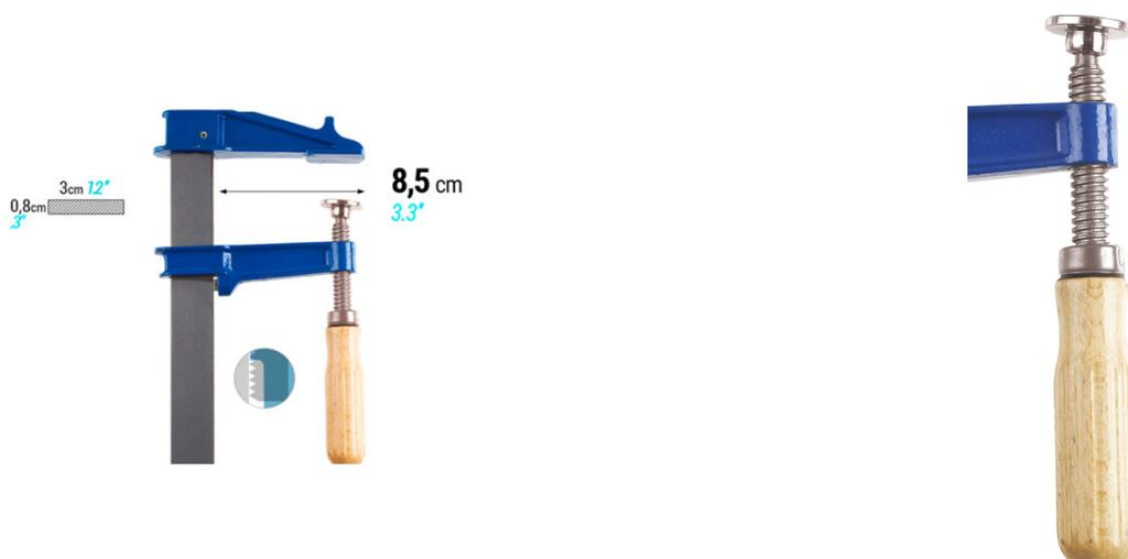
Le serre-joint Mod. EM de PIHER est un serre-joint pratique avec filetage trapézoïdal et un manche en bois. Ils ont une barre en acier roulé extra résistant (90kg / mm<sup>2</sup>), un frein antidérapant sur la mâchoire mobile et les mâchoires sont recouvertes d'une peinture époxy.
