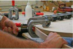
Ces serre-joints à coins ont un design moderne et sont de forme ergonomique. Ils sont pratique, légers et sont spécialement conçus pour un usage une main. Ils ont un corps en aluminium et une poignée en bois. Épaisseur
