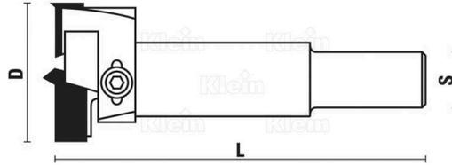
Plaquette de rechange de diamètre 30mm-45mm pour le mèche à façonner réglable de Sistemi Klein (UGS: KL-R110600R).
