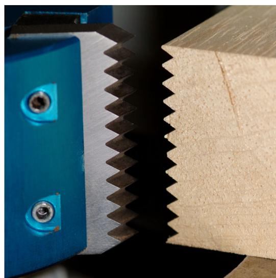
Ce porte outils à profiler a été conçu pour les petites fraiseuses avec un diamètre d'alésage de 20 mm. Le
