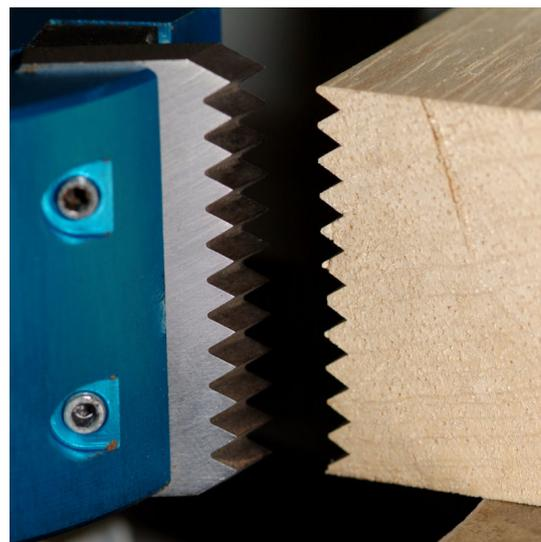
Ce porte outils à profiler a été conçu pour utilisation sur les machines à fraiser avec alésage de 30 mm. Le porte outils est compatible avec tous les lames jusqu'à une hauteur de 40mm.
