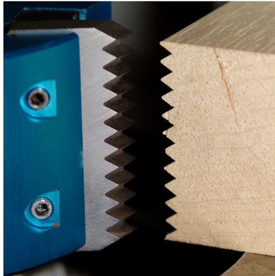
Porte outils d'une hauteur de 90 mm pour utilisation sur des fraiseuses à broche de 30 mm. Cette tête peut être utilisée avec tous nos couteaux de profil de hauteur 90 mm. Ces hauts profils sont principalement utilisés pour le fraisage des lambris, des corniches ou des profils de toit.
