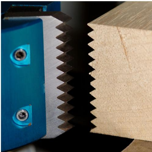
Porte outils universel avec possibilité de monter presque tous les couteaux disponible sur le marché maintenant. Le porte outils peut porter aussi bien des couteaux profilés de 40 mm et 50 mm de hauteur que des couteaux remplaçables et des couteaux réversibles jusqu'à 50 mm. Grâce aux araseurs en haut et en bas, votre travail de fraisage est toujours propre. Convient également pour les rabais.
